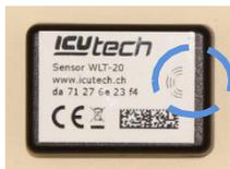
Der Sensor muss vor dem ersten Gebrauch mit dem mitgelieferten Magnetknopf aktiviert werden. Dazu an der gekennzeichneten Stelle (siehe Bild links) mit dem Magnetknopf über den Sensor streichen. Gleiches Vorgehen für WLRT und WLRHT Sensoren anwenden. Bitte ausschliesslich den mitgelieferten ICU tech Magnetknopf verwenden.
