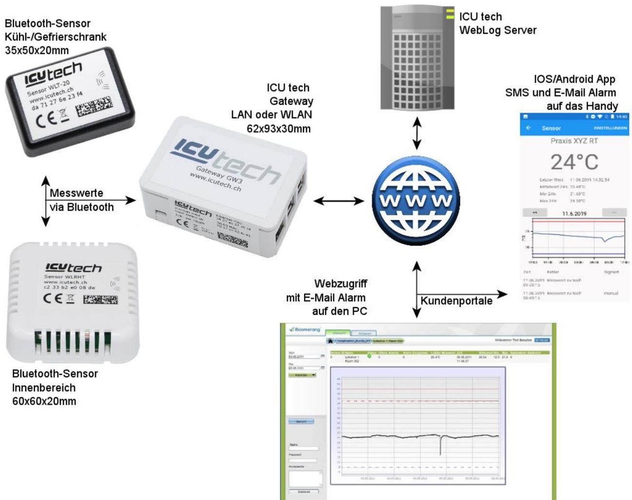
Die Temperaturüberwachung erfolgt via **Bluetoothsensor**.
