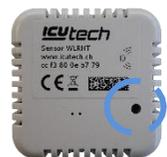
Sensoren für Kühlgeräte (WLT-20) mit Tastknopf sind auf der Gehäuseunterseite mit einem punktförmigen Aufkleber markiert. Der Tastknopf zur Aktivierung befindet sich auch auf der Gehäuseunterseite. Eine einmalige Betätigung des Tastknopfs aktiviert den Sensor. Fehlt dieser Aufkleber muss der Sensor mit dem Knopfmagneten aktiviert werden. Dazu an markierter Stelle (Halbkreis auf linkem Bild) mit dem Magnetknopf über den Sensor streichen.
